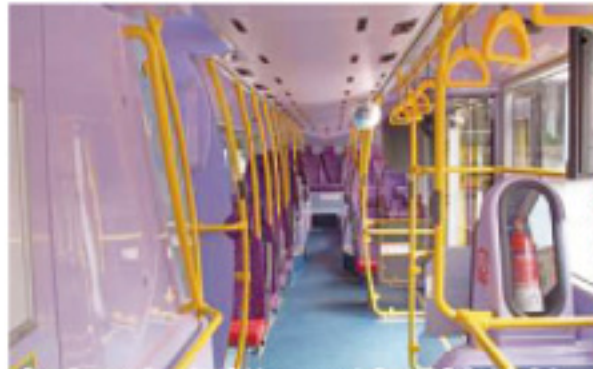
車廂設顏色鮮明及連貫性的扶手，由上車門位置伸延至車尾，方便視障人士進出車廂
